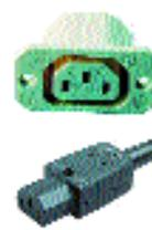
Bild 2: Kaltgerätestecker und -dose, hier kann der Anwender den Stecker nur in einer Richtung einstecken; Lage von L und N ist definiert
