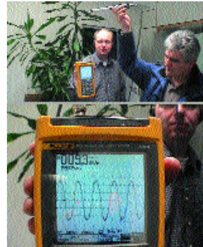
Bild 5: Leuchte mit elektronischem Vorschaltgerät strahlt elektromagnetisches Feld mit einer Frequenz von 26,42 kHz ab
